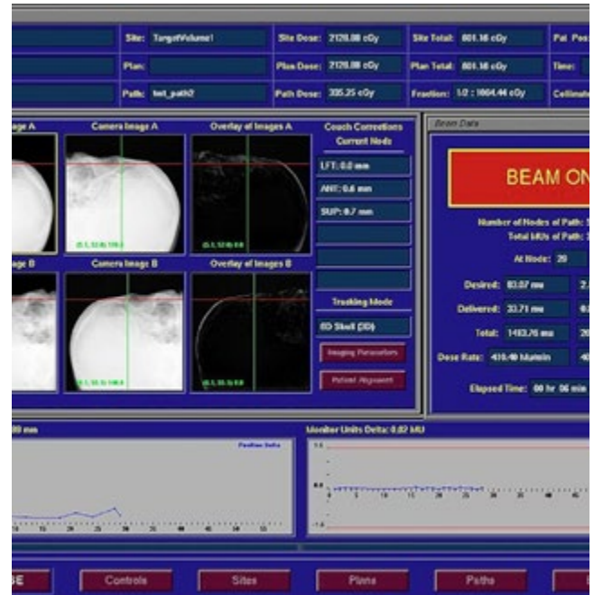
Abb. 3; Screenshot der CyberKnife Steuerungssoftware. Die linke Spalte zeigt digital rekonstruierte Röntgenbilder (DRR), die aus CT-Aufnahmen errechnet wurden. In der mittleren Spalte sind intra-operativ angefertigte Röntgenaufnahmen zu sehen, die in der rechten Spalte mit den DRR überlagert werden, um die Tumorlokalisierung auf visuellem Wege zu überprüfen. Quelle: http://en.wikipedia.org/wiki/File:6DSkull.jpg , © 2007 Wikipedia User Steven3045 (letzter Zugriff: 20/02/2014, 11:00)
